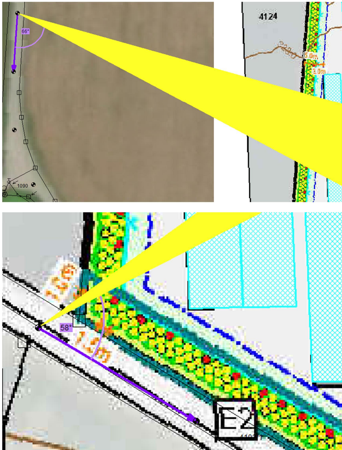
Abbildung 4.2: Blickwinkelanalyse der Pöringer Straße (gelb: Reflexionsstrahlen, violett: Fahrtrichtung)
