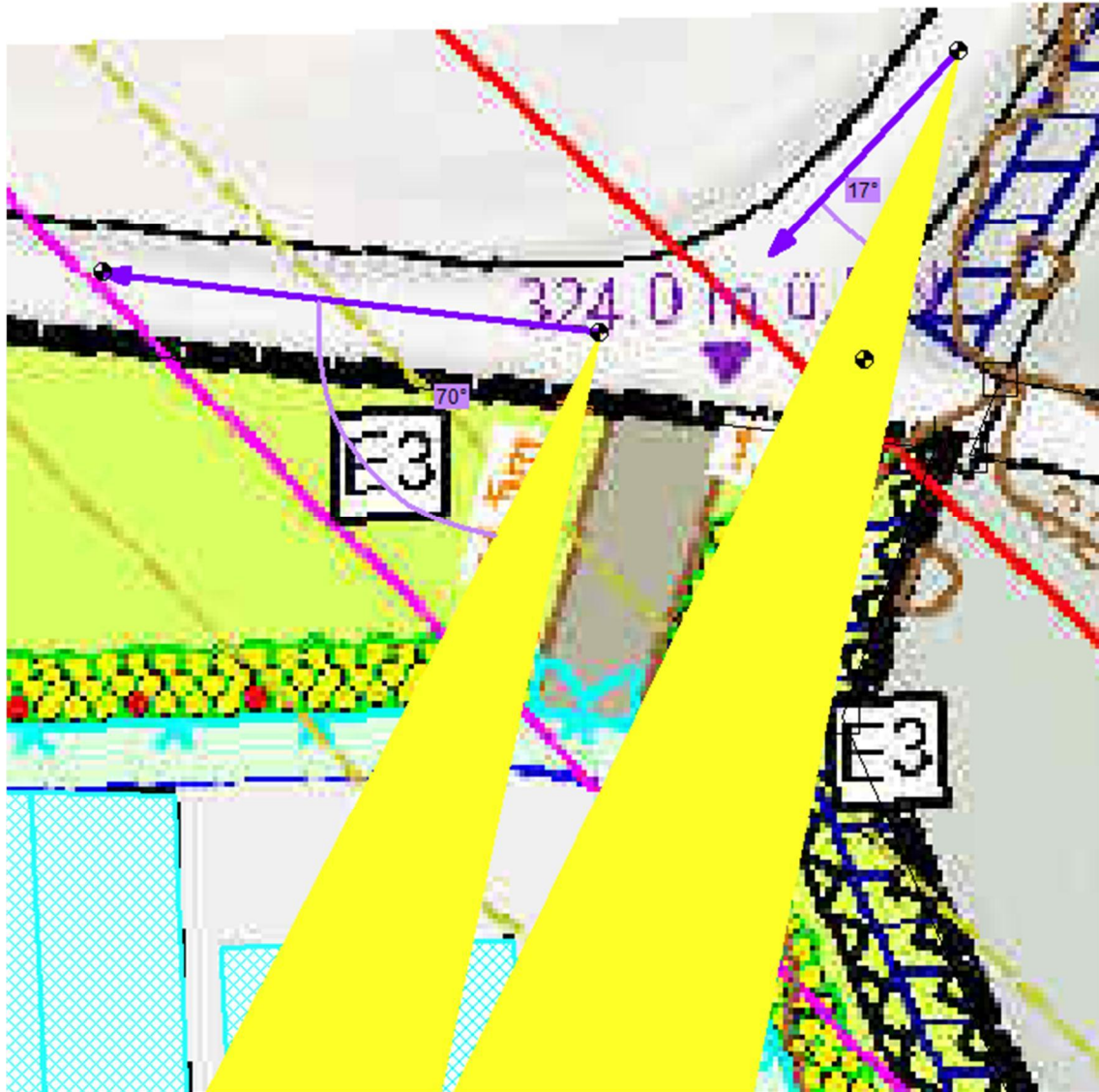
Abbildung 4.3: Blickwinkelanalyse der Mühlholzweg (gelb: Reflexionsstrahlen, violett: Fahrtrichtung)
